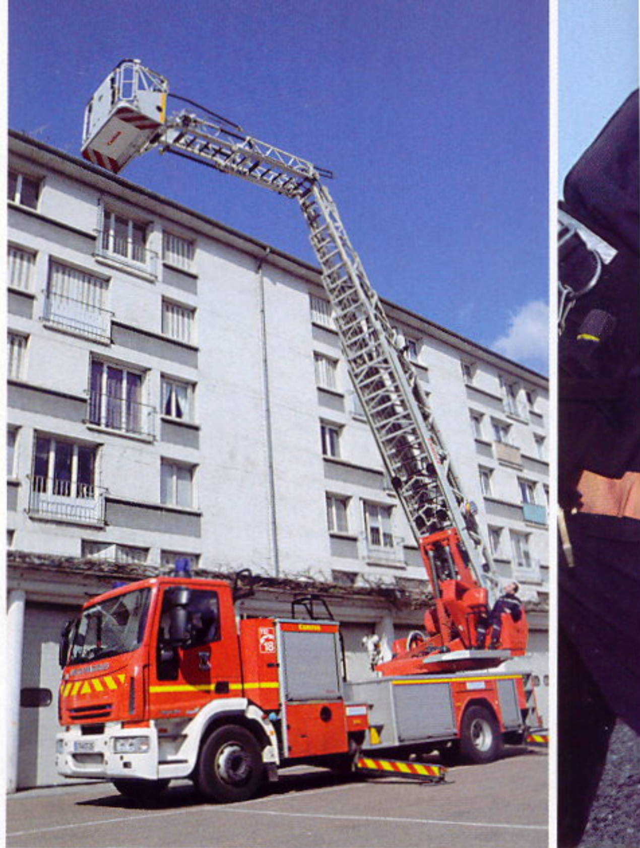
Cette EPA basée au CSP de Besançon possède le dernier plan articulé et télescopique qui lui permet d'accéder aux parties difficilement accessibles.
